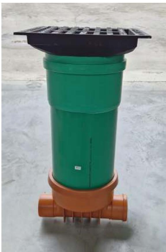
Der SABUG Trennschacht besteht als Gesamtpaket aus einem Schachtkörper aus Polypropylen (PP) und einer Vollguss-Abdeckung D 400. Die Abdichtung zwischen dem Schachtkörper und der Abdeckung erfolgt mittels der SABUG Quelledichtung DN 400. Bei geringen Tiefen empfehlen wir die Abdeckung mit einem Ortbetonrahmen entsprechend zu verstärken.
