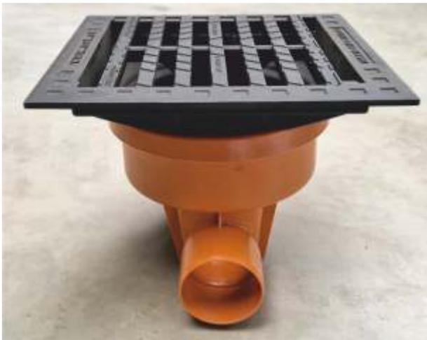
Der SABUG-Straßenablauf und der SABUG-Durchgangsschacht besteht als Komplettpaket ebenfalls aus einem Schachtkörper aus Polypropylen (PP) und einer Vollguss-Abdeckung D 400. Die Abdichtung zwischen dem Schachtkörper und der Abdeckung erfolgt mittels der SABUG Quelledichtung DN 400. Bei geringen Tiefen empfehlen wir die Abdeckung mit einem Ortbetonrahmen entsprechend zu verstärken.
