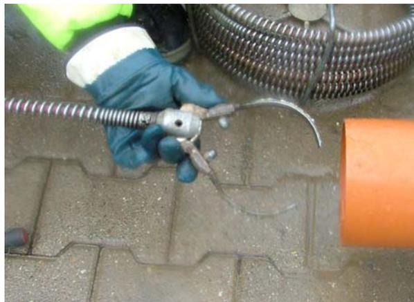
Abb. 53: Mechanischer Wurzelschneider zur Beseitigung von Wurzelschäden.
