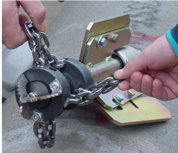
Abb. 52: Kettenschleuder zur Beseitigung von Wurzelschäden.
