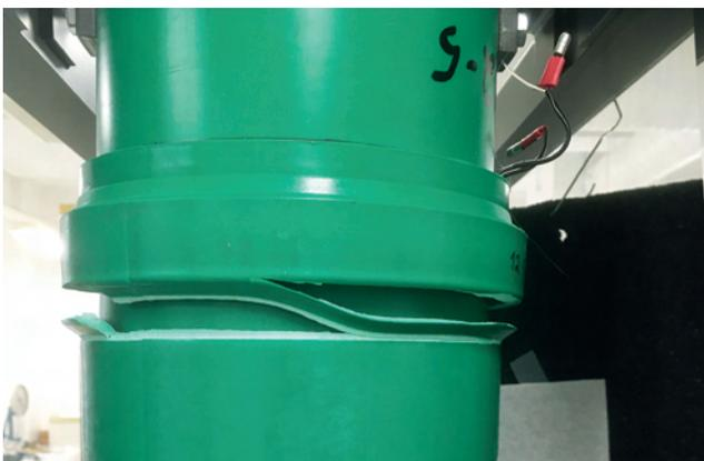
denen Laboratorien zeigen eine überragende Festigkeit des IP-plus Cable Ducting Schweißsystem im Gesamtverband. Es wurde eindeutig festgestellt, dass bei Überlastung vor dem Versagen der Schweißverbindung das Rohr bricht.
