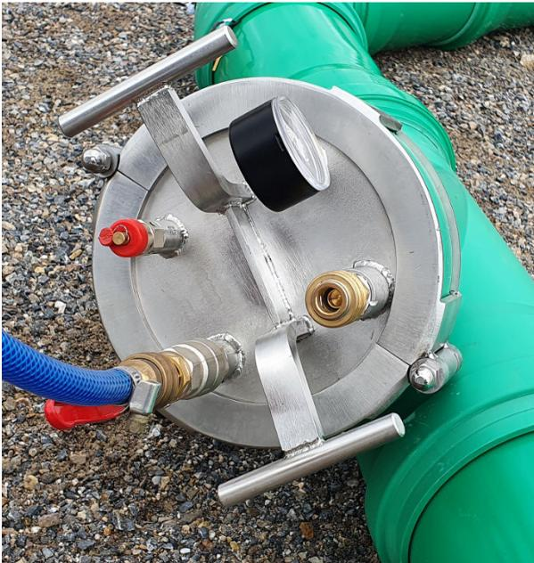
Die Prüfarmatur muss komplett bis zum Anschlag in die Muffe eingeschoben werden. Zur Montage der Prüfarmatur verwenden Sie bitte die Montagegriffe. Mit diesen Griffen lässt sich die Prüfarmatur äußerst einfach platzieren.
