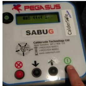
5. Lösen der Kontakte und Vorbereitung der nächsten Schweißung kann vorsichtig direkt nach der Verschweißung erfolgen. Das Rohr darf allerdings unter keinen Umständen in der Lage verändert werden. Druckproben und Verfüllung dürfen erst nach Ablauf der Abkühlzeiten erfolgen!
