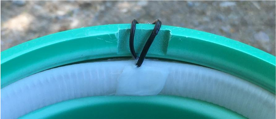
Bitte reinigen Sie vor der Berührung des IP-plus Schweißringes auch die Hände gründlich oder verwenden Sie saubere – am besten NEUE Handschuhe! Es ist unbedingt zu vermeiden, dass der Schweißring oder die gereinigten Rohrteile durch Schmutz oder Fett/Öl verunreinigt werden.
