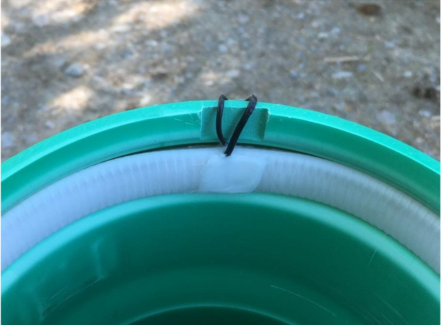
Weißverfärbungen im Bereich der Verbindungsnaht die deutlich von der normalen Ringfarbe abweichen, weisen auf einen Bruch hin. Bitte verwenden Sie den Schweißring dann nicht mehr!
