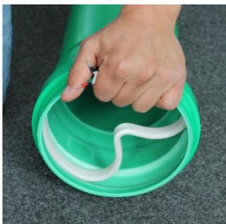
3. Nach dem Lösen der Arretierung beginnt der Schweißring sich in die Sicke der Rohrmuffe zu legen.
