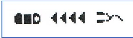
Sollten Sie die Anschlusskabel des Schweißringes noch nicht mit den Steckern des Schweißgerätes verbunden haben, wird Ihnen das oben gezeigte Piktogramm auf dem Display angezeigt.
