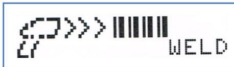
Sie werden nun aufgefordert den Barcode auf der Verpackung des Schweißringes mit Hilfe des Barcode Lesers einzulesen. Halten Sie dafür den Barcode Leser direkt auf den Barcode auf der Verpackung und betätigen Sie den Schalter an dem Barcode Leser.
