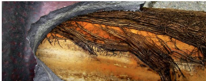
Sanierung von Wurzelschäden: Die Wurzeln konnten sich nur zwischen Liner und Altrohr ausbreiten
