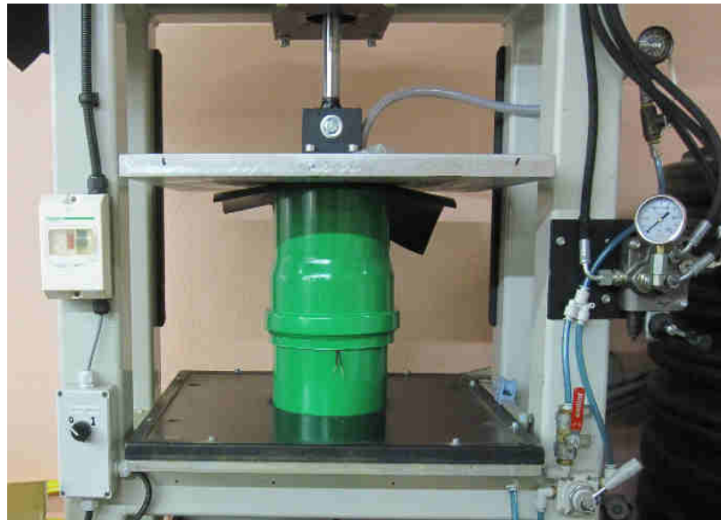
Prüfstand zur Aufnahme der Innendruckkräfte im Rohrsystem
